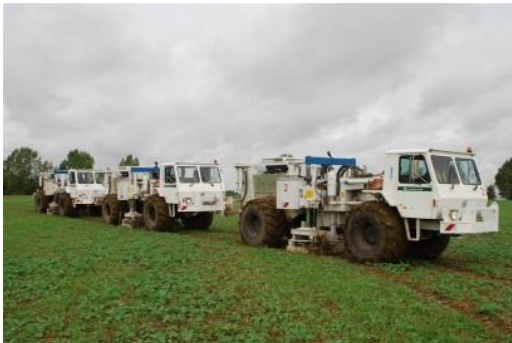
Ilyen önjáró járműveket – szeizmikus vibrátor – láthatnak majd a kutatási területen
