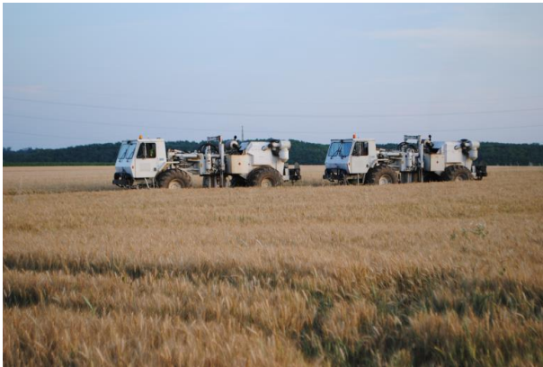
Munkatársaink ilyen önjáró vibrátor járművekkel keltenek majd mesterséges rezgéseket
